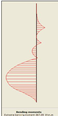
Figure 31. Bending Moment ( $\phi=13^\circ$ ,  $c=32 \text{ kN/m}^2$  and  $H_w=20 \text{ m}$ )
