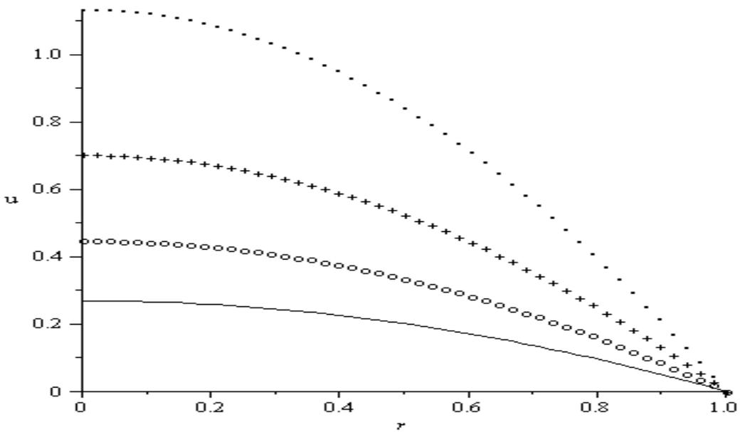
**Figure 4.** Velocity profile:  $Br = 1$ ;  $\alpha = 1$ ;  $Bi = 1$ ; \_\_\_\_\_  $G = 1$ ; ooooo  $G = 1.5$ ; +++++  $G = 2$ ; .....  $G = 2.5$ .
